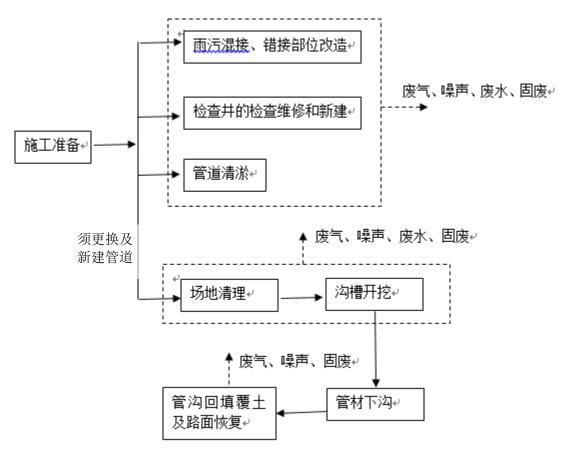
图 5-1 施工流程及产污环节图
