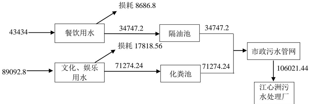
图 2-1 建设项目用水平衡图 (t/a)
