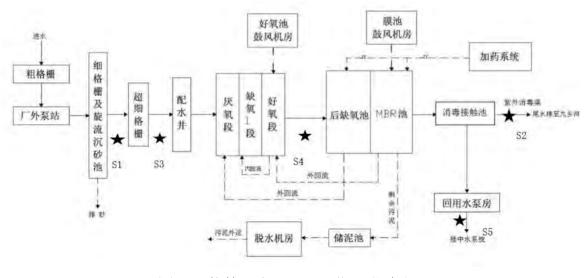
图 7-2 仙林污水处理厂二期工艺流程
