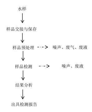
图 5-1 项目工艺流程与产污节点图
