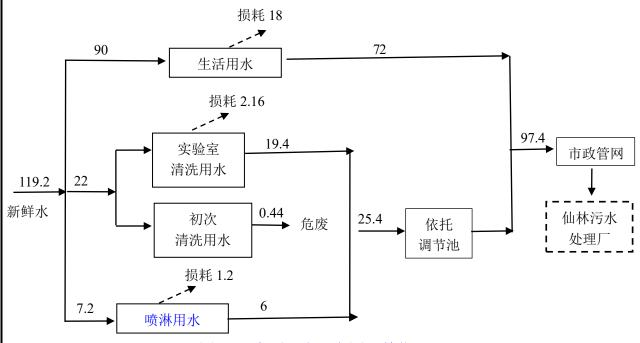
图 5-2 本项目水平衡图 单位: t/a
