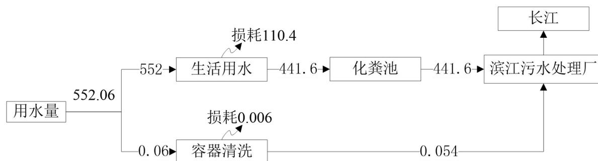
图 5-2 项目水平衡图(t/a)
