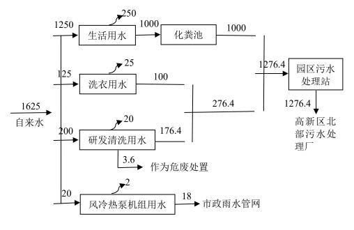
图 2-1 扩建项目水平衡图 (t/a)
