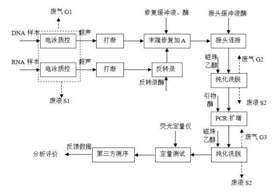
图 2-3 高通量建库试剂盒研发工艺流程和产污环节
